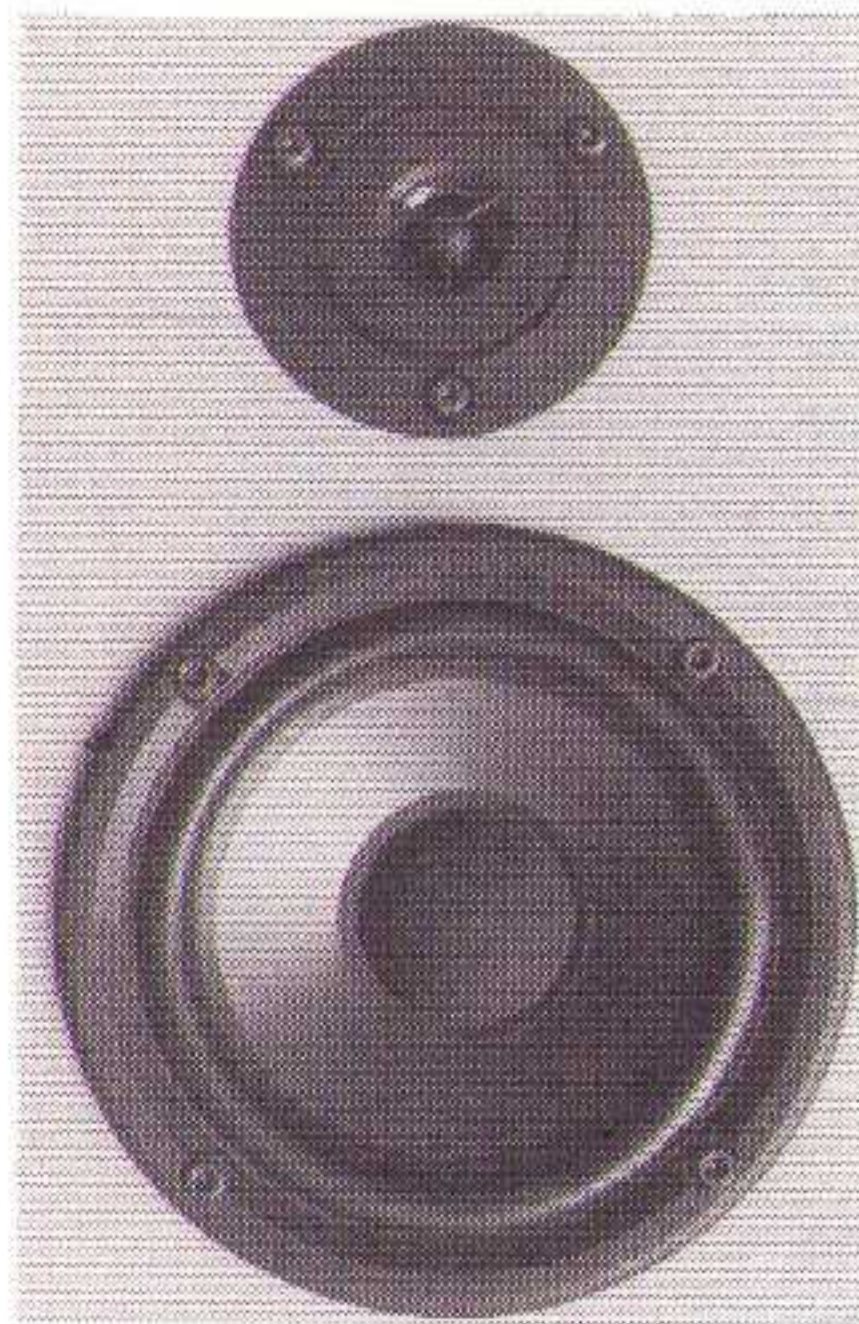
De units voor 'Freek'. Boven de Audax tweeter en daaronder de Bravo basunit.
